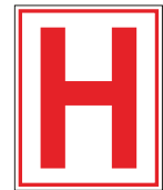
Pic. 410 Ondergronds hydrant
