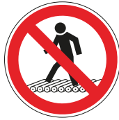
Pic. 830 Verboden de rollenbaan te betreden
