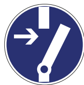
Pic. 278 Schakelen voor ingebruikname
