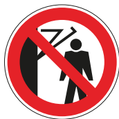
Pic. 602 Verboden onder hendel te lopen
