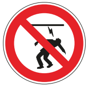
Pic. 231 Aanraken van sterkstroomkabel verboden
